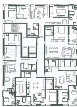
HOCHHAUS MIETWOHNUNGEN Möbliert, pro Geschoss 5 Wohnungen
